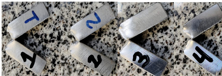
Figura 8 – Corpos de prova após teste de impacto Charpy
