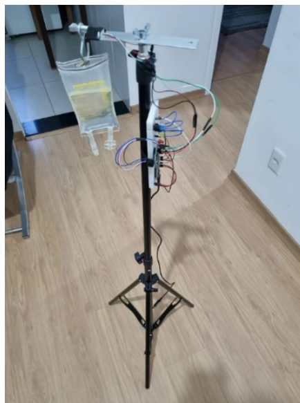
Figura 4: Protótipo físico do sistema SoroTech (Fonte: Autor)
