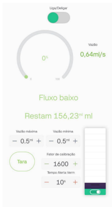
Figura 2 - Interface do aplicativo SoroTech desenvolvido no Software Blynk (Fonte: Autor)
