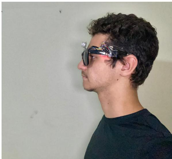
Figura 9. Protótipo final dos óculos assistivo montado em uma pessoa
