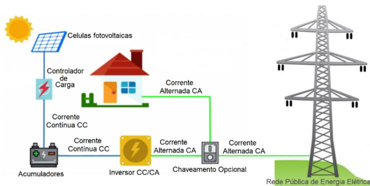
Descrevendo a integração de sistemas de geração utilizando células fotovoltaicas ou células solares em sistemas de forma local, independente da rede elétrica, figura 7.
