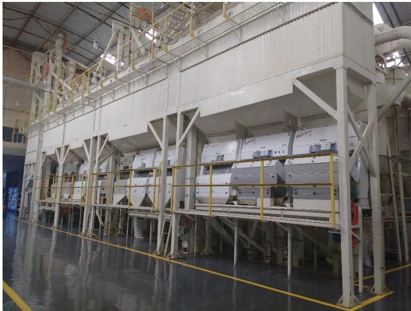
Figura 17- Seleccionadoras Eletrônicas de Arroz (COPIRIL, 2016)
