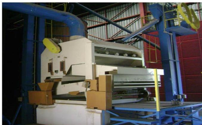
Figura 5 – Máquina de ar e peneira utilizada para limpeza de grãos a granel (EMBRAPA, 2011)
