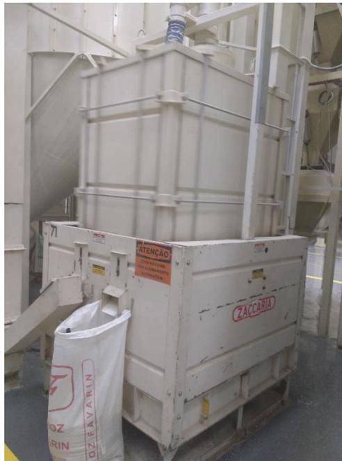
Figura 16-Maquina Classificadora plano rotativo (CORIPIL, 2016)
