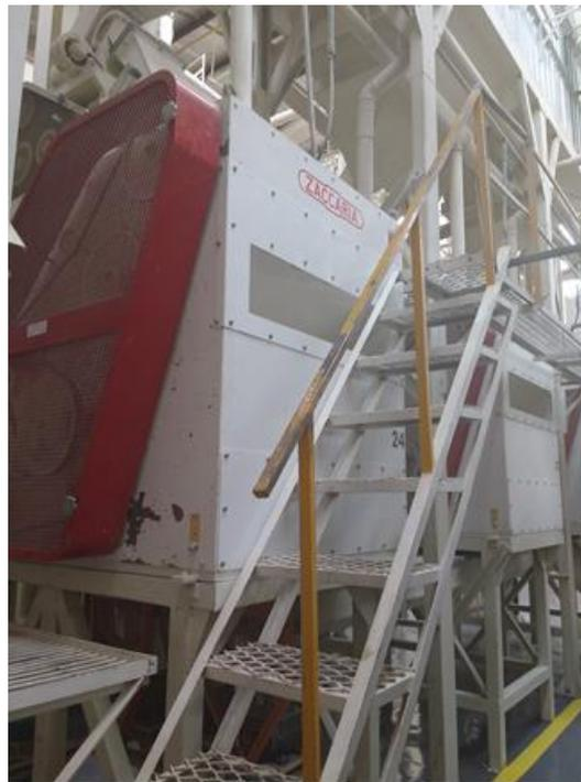
Figura 12 – Descascador de arroz (COPIRIL, 2016)
