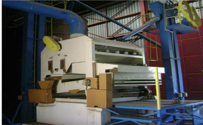
Figura 8 - Máquina de ar e peneira utilizada para limpeza de grãos a granel (EMBRAPA, 2011)
