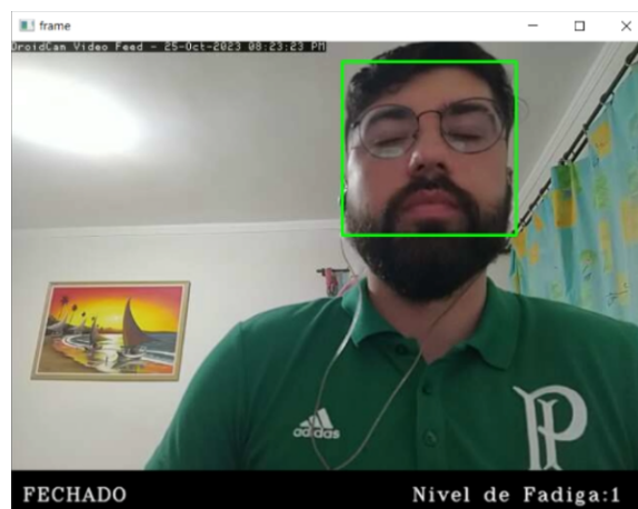
Figura 16 - Algoritmo detectando piscada (olho fechado durante a piscada, nível de fadiga sobe para 1).
