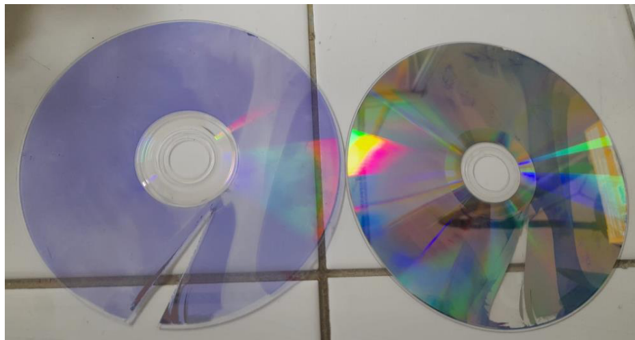
Figura 8 – Separação das camadas do DVD-R
