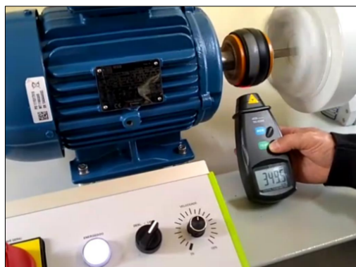
Figura 6. Medição da velocidade de rotação do motor.
