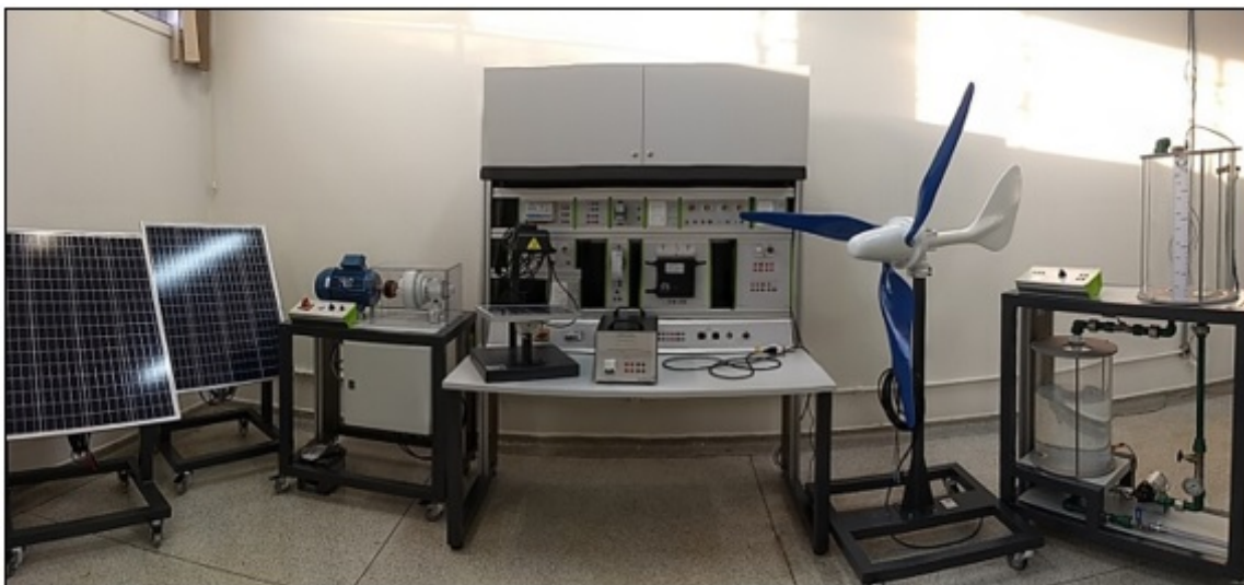
Figura 4 - Bancada didática híbrida de energias renováveis eólica e fotovoltaica.
