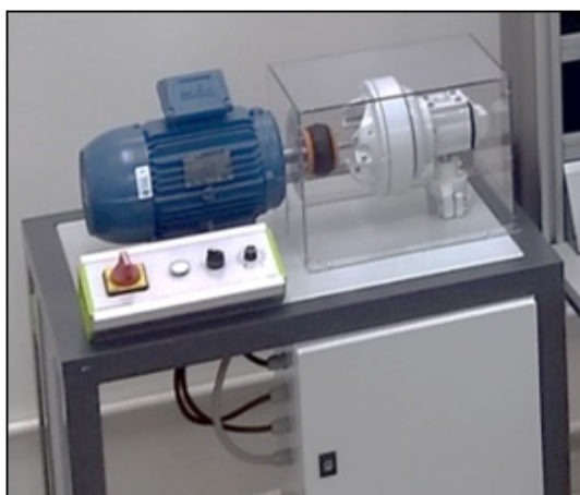
Figura 5 - Detalhe do motor com inversor de frequência existente na bancada.
