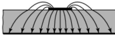
Figura 1 -Efeito de borda na microlinha ocorrido com a presença de um substrato
