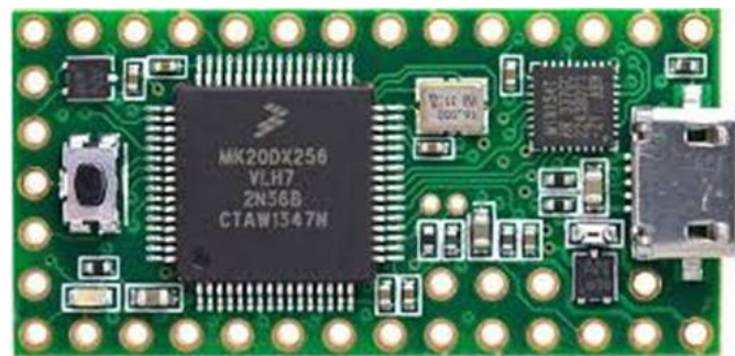
Figura 7 - Módulo Teensy 3.2 USB.
