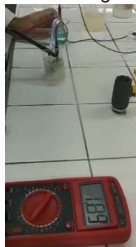
Figura 10 - Multímetro digital ligado aos eletrodos
