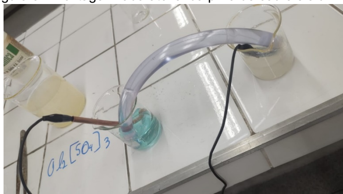
Figura 9 - Montagem laboratorial da pilha de cobre e alumínio
