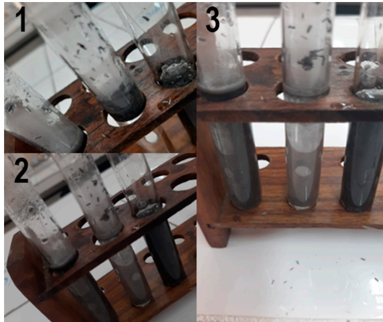
Figura 8 - Reação do magnésio com o ácido clorídrico 20%
