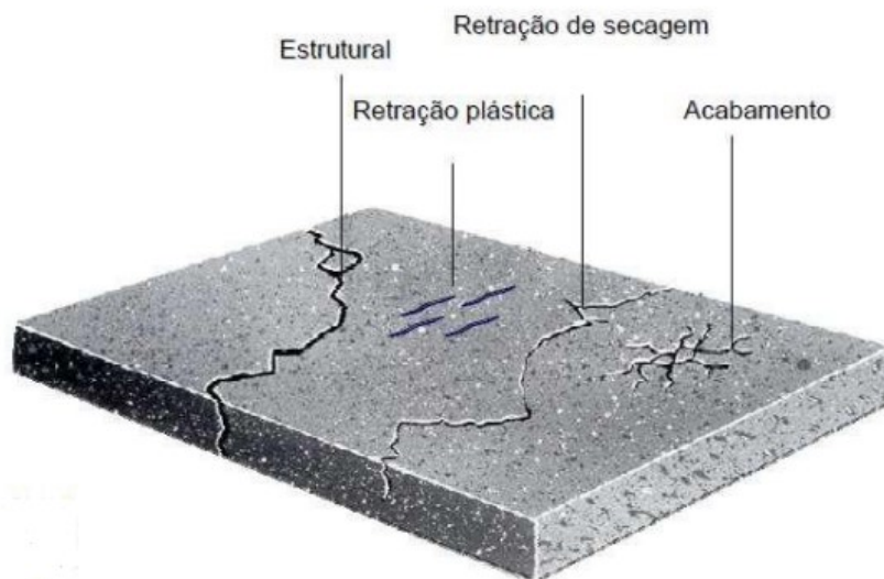
Figura 17 – Fissuras aparentes nos revestimentos
