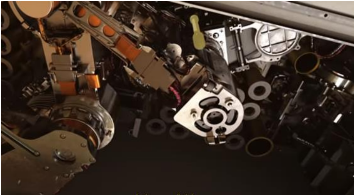
FIGURA 3: Detalhe da parte inferior do Perseverance, onde o braço robótico secundário coleta a amostra, que é o componente destacado em amarelo, do carrossel (NASA, 2020).
